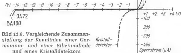
Bild 11.8. Vergleichende Zusammenstellung der Kennlinien einer Germanium- und einer Siliziumdiode und eines Kristalldetektors
