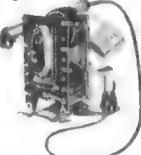
**ZEILENTRAFO ZTR 016 =** PHILIPS AT 2016, f. Bi.-Röhren AW 43-88, AW 53-88, für Röhren DY 86, PL 36, PY 88, Hochsp. 16 kV, Speisesp. 220 V, Boosterspannung 1050 V **22.50**
