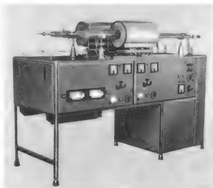
Bild 5. Diffusionsanlage mit Ein- und Zweizonenofen für die Halbleiterfertigung
