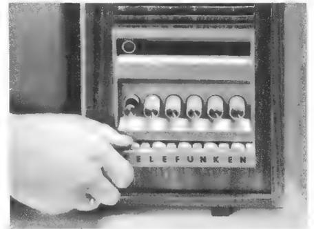
Bild 1. Kompaktabstimmung im Empfänger FE 344 T. Unten: herausziehbares Fach mit Einstellern, oben: Trommelskala, in der Mitte: sechs leichtgängige Drucktasten für alle Bereiche
